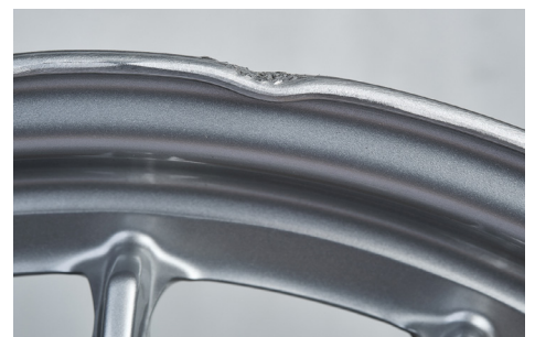
Beispiel Delle - nicht aufzubereiten
