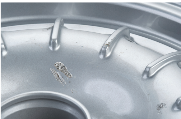
Aufbereitung NICHT zulässig, da die Beschädigung mit 1 mm Tiefe in das Grundmetall weiter als 50 mm vom Außenhorn nach innen liegt
