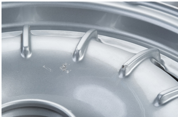
Aufbereitung grundsätzlich zulässig, da die Beschädigung nur die Lackschicht betrifft
